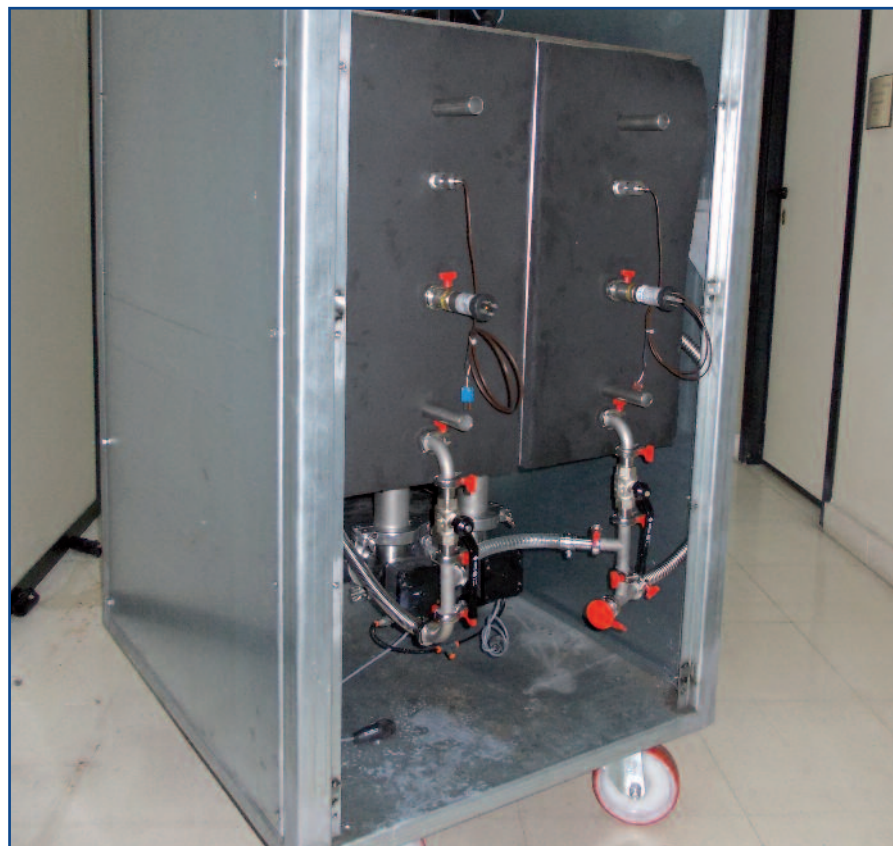
> Vista generale della macchina ad adsorbimento realizzata da CNR-ITAE
