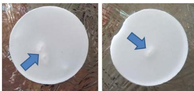
**Fig.1.** Esempi di difetti riscontrati durante la produzione di membrane rinforzate con  $\varnothing=50$  mm.
