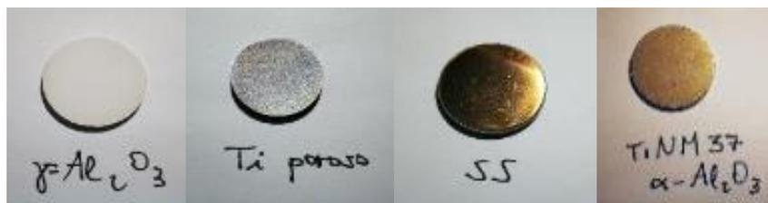
Fig. 26: Substrati di allumina modificata, Ti poroso, acciaio inox e TiNM37 dopo trattamento in syn-gas.
