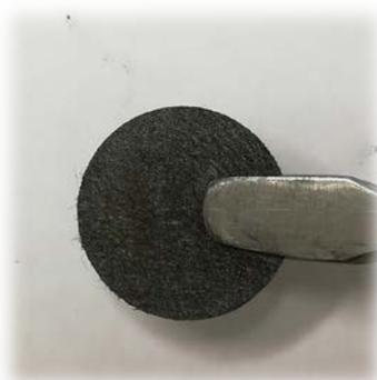
Fig. 16. Campione "NP1800HG" depositato su supporto in CF
