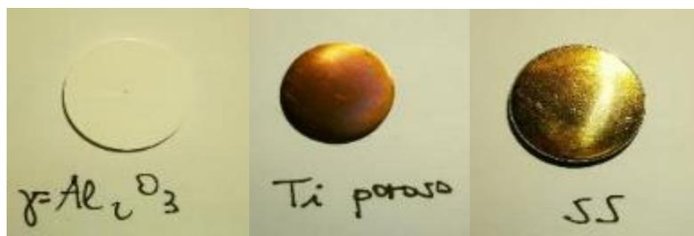
Fig. 27: Substrati di allumina modificata, ti poroso e acciaio inox dopo trattamento in ArH<sub>2</sub> 3%.
