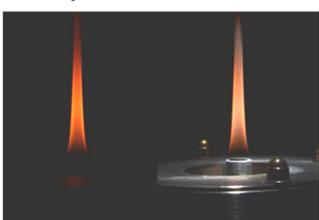
Dimostratore combustore-solare: a fiamma di partenza (sx) e fiamma irraggiata da lampada solare (dx)
