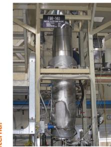
Impianto a letti bollenti da 40kWth utilizzato nei test di ottimizzazione della configurazione reattoristica
