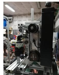
Motore completo con scambiatore di recupero del calore e catalizzatore integrato
