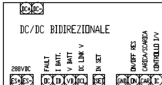
Fig. 2.2.11 Schema del convertitore DC/DC bidirezionale con morsetti di potenza, acquisizione e controllo.
