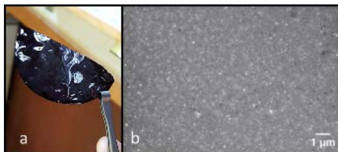
Figura 3 a) Film di PANI-CSA/SWCNH 15wt% b)micrografia FE-SEM in elettroni secondari di PANI-CSA/ SWCNH 15wt%.
