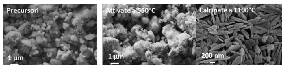
Fig. 1. Micrografie SEM delle polveri considerate in questo studio
