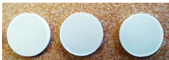
Fig. 6. Esempi di membrane rinforzate a base di Na- \beta'' -Al 2 O 3 + 15% vol di YSZ.
