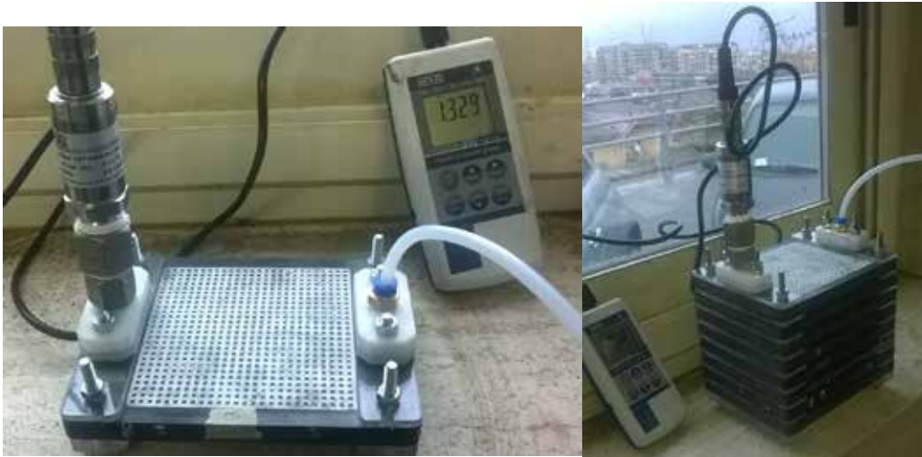
Figura 35: test di tenuta in pressione, singoli piatti e intero prototipo.
