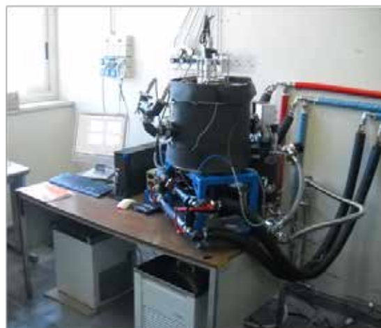
Figura 25 Impianto per la misura della cinetica di adsorbimento.
