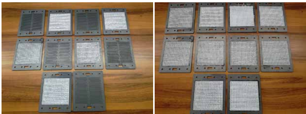
Figura 31: Insieme delle piastre rivestite. Si noti la differenza tra il lato "processo", con il coating, e il lato "fluido".
