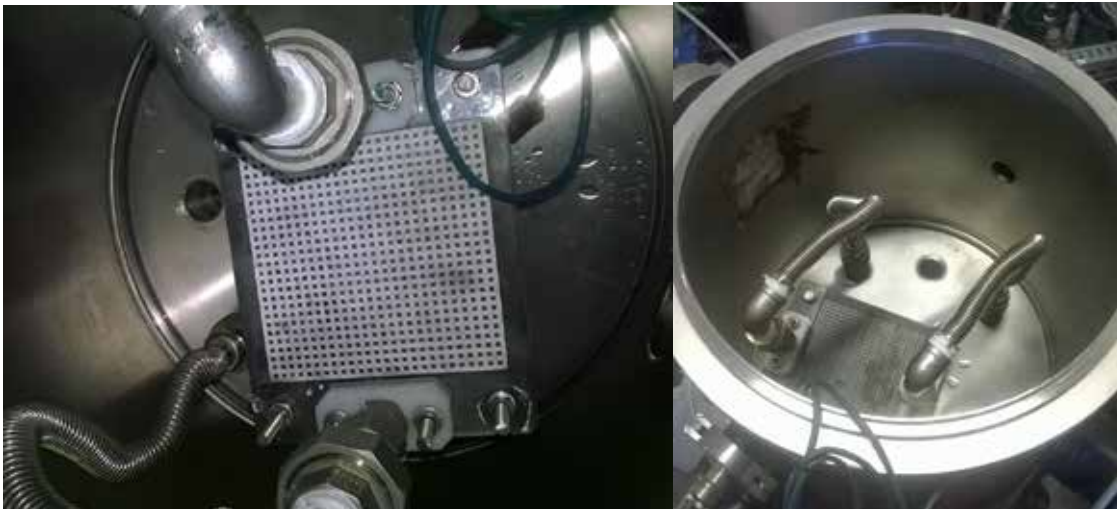
Figura 37: prova idraulica prototipo di adsorbitore in grafite.
