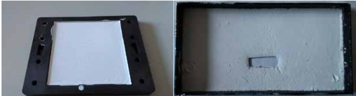
Figura 26 Immagine dei due adsorbitori realizzati: grafite (sinistra), alluminio (destra)
