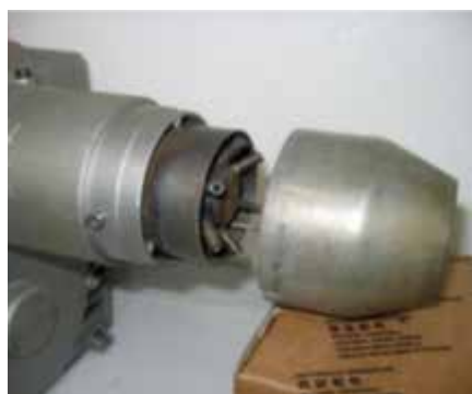
Figura 8: Bruciatore per gas/liquidi a diffusione a flussi paralleli installato presso il laboratorio del IRC-CNR.
