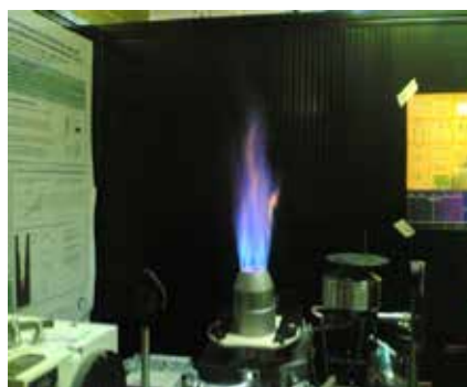
Figura 8: Bruciatore per gas/liquidi a diffusione a flussi paralleli installato presso il laboratorio del IRC-CNR.
