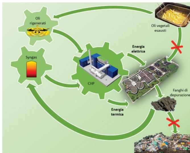
> Schema del sistema integrato sviluppato nel progetto PANACEA.
